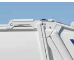
4 Cilindros de elevação da cuba de resíduos.
